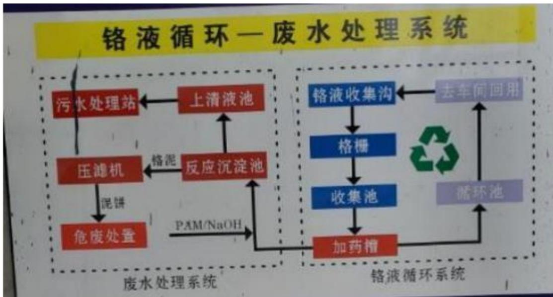
图4-3 含铬废水循环回收处理工艺流程图
